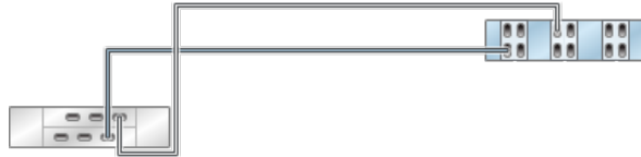
그림 278 독립형 7420 컨트롤러의 HBA 6개가 DE2-24 Disk Shelf 2개에 2줄 체인으로 연결됨
