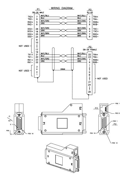
Figure 203: E5-ENET FAST COPY ADAPTER, UPPER, P/N 830-1343-01
