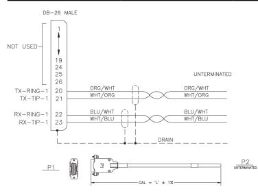
Figure 196: DS1 Cable DS1 Cable
