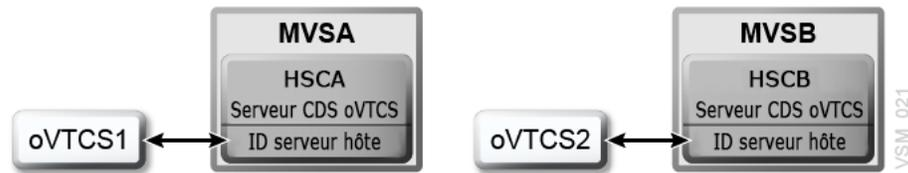
Les cases "ID d'hôte de serveur" de la [Figure 6.2, « Relation entre client oVTCS et serveur de BdD CDS oVTCS »](#) représentent le serveur sur lequel la commande *DBSERVer* est émise (voir la section [« Commande DBSERVer »](#)). C'est aussi l'hôte qui fournit l'ID d'hôte proxy pour le CDS de client oVTCS. Ainsi, oVTCS1 correspond à l'ID d'hôte MVSA et oVTCS2 à l'ID d'hôte MVSB. Notez que MVSA et MVSB peuvent partager le même CDS, mais qu'ils doivent avoir des ID d'hôte distincts.
