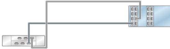
图 194 具有四个 HBA 且通过两个链连接到两个 DE2-24 磁盘机框的单机 ZS4-4/ZS3-4 控制器
