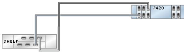
图 324 具有五个 HBA 且通过两个链连接到两个 DE2-24 磁盘机框的单机 7420 控制器
