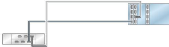
图 186 具有三个 HBA 且通过两个链连接到两个 DE2-24 磁盘机框的单机 ZS4-4/ZS3-4 控制器
