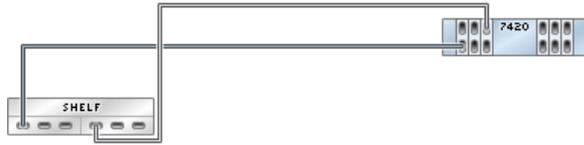
图 408 具有六个 HBA 且通过两个链连接到两个 Sun Disk Shelf 的单机 7420 控制器
