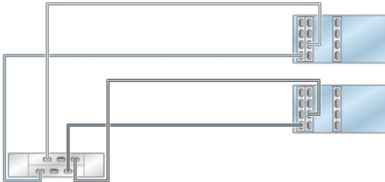
图 280 具有三个 HBA 且通过两个链连接到两个 DE2-24 磁盘机框的群集 7420 控制器
