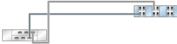
图 332 具有六个 HBA 且通过两个链连接到两个 DE2-24 磁盘机框的单机 7420 控制器
