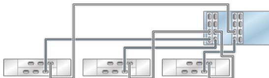
图 196 具有四个 HBA 且通过四个链连接到四个 DE2-24 磁盘机框的单机 ZS4-4/ZS3-4 控制器
