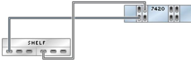
图 395 具有四个 HBA 且通过两个链连接到两个 Sun Disk Shelf 的单机 7420 控制器
