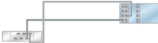
图 256 具有三个 HBA 且通过两个链连接到两个 DE2-24 磁盘机框的单机 7420 控制器
