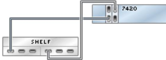
图 386 具有两个 HBA 且通过两个链连接到两个 Sun Disk Shelf 的单机 7420 控制器
