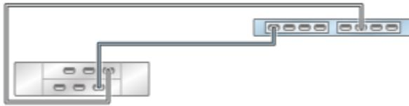
图 232 具有两个 HBA 且通过两个链连接到两个 DE2-24 磁盘机框的单机 ZS3-2 控制器
