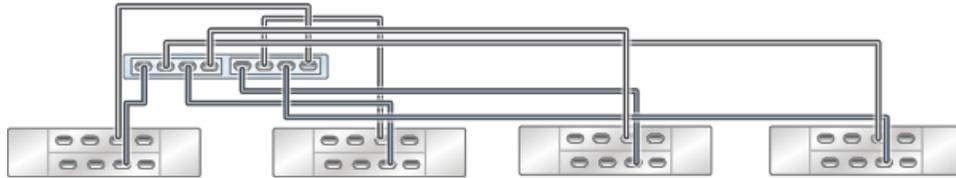
图 108 具有两个 HBA 且通过四个链连接到八个 DE3-24 磁盘机框的单机 ZS3-2 控制器
