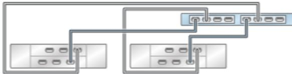
图 233 具有两个 HBA 且通过三个链连接到三个 DE2-24 磁盘机框的单机 ZS3-2 控制器
