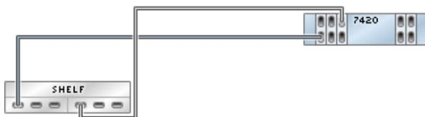
图 401 具有五个 HBA 且通过两个链连接到两个 Sun Disk Shelf 的单机 7420 控制器
