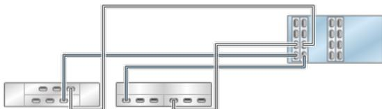
图 480 具有四个 HBA 且通过三个链连接到三个混合磁盘机框的单机 ZS3-4 控制器 (DE2-24 显示在左侧)
