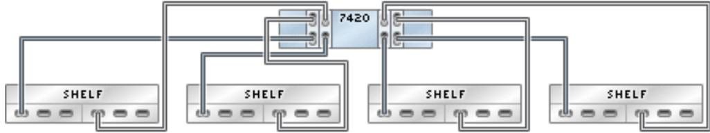
图 398 具有四个 HBA 且通过四个链连接到八个 Sun Disk Shelf 的单机 7420 控制器
