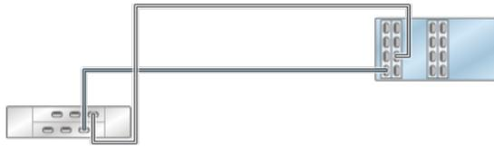
图 264 具有四个 HBA 且通过两个链连接到两个 DE2-24 磁盘机框的单机 7420 控制器
