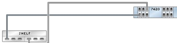
**FIGURE 408** Contrôleur 7420 autonome avec six HBA connectés à deux étagères de disques Sun Disk Shelf dans deux chaînes
