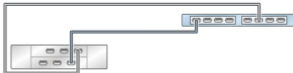
**FIGURE 232** Contrôleur ZS3-2 autonome avec deux HBA connectés à deux étagères de disques DE2-24 dans deux chaînes
