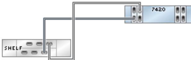
**FIGURE 317** Contrôleur 7420 autonome avec quatre HBA connectés à deux étagères de disques DE2-24 dans deux chaînes
