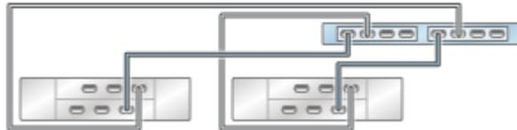
**FIGURE 233** Contrôleur ZS3-2 autonome avec deux HBA connectés à trois étagères de disques DE2-24 dans trois chaînes
