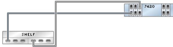
**FIGURE 401** Contrôleur 7420 autonome avec cinq HBA connectés à deux étagères de disques Sun Disk Shelf dans deux chaînes
