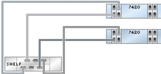
**FIGURE 352** Contrôleurs 7420 en cluster avec quatre HBA connectés à deux étagères de disques DE2-24 dans deux chaînes
