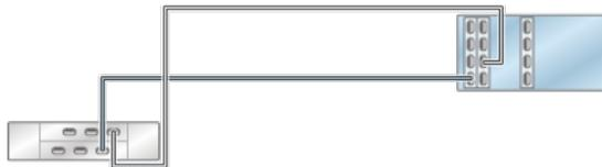
**FIGURE 186** Contrôleur ZS4-4/ZS3-4 autonome avec trois HBA connectés à deux étagères de disques DE2-24 dans deux chaînes
