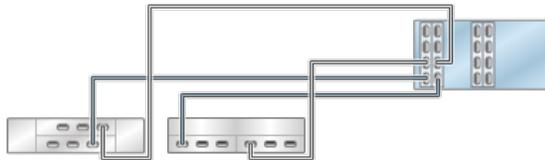
**FIGURE 480** Contrôleurs ZS3-4 autonomes avec quatre HBA connectés à trois étagères de disques mixtes dans trois chaînes (DE2-24 affiché à gauche)
