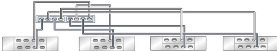
**FIGURE 108** Contrôleur ZS3-2 autonome avec deux HBA connectés à huit étagères de disques DE3-24 dans quatre chaînes
