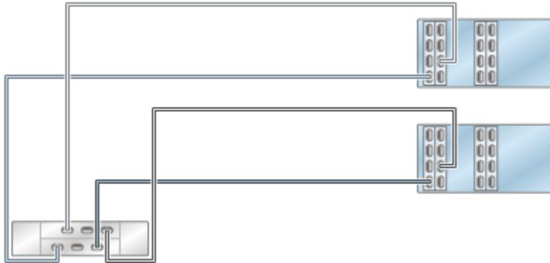
**FIGURE 218** Contrôleurs ZS4-4/ZS3-4 en cluster avec quatre HBA connectés à deux étagères de disques DE2-24 dans deux chaînes
