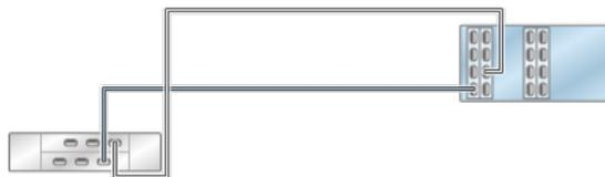
**FIGURE 194** Contrôleur ZS4-4/ZS3-4 autonome avec quatre HBA connectés à deux étagères de disques DE2-24 dans deux chaînes
