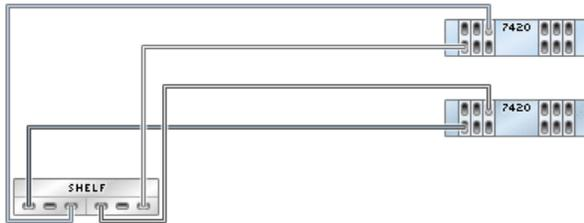
**FIGURE 438** Contrôleurs 7420 en cluster avec six HBA connectés à deux étagères de disques Sun Disk Shelf dans deux chaînes
