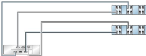
**FIGURE 367** Contrôleurs 7420 en cluster avec six HBA connectés à deux étagères de disques DE2-24 dans deux chaînes
