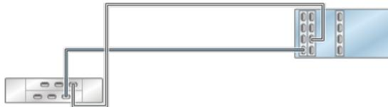
**FIGURE 256** Contrôleur 7420 autonome avec trois HBA connectés à deux étagères de disques DE2-24 dans deux chaînes
