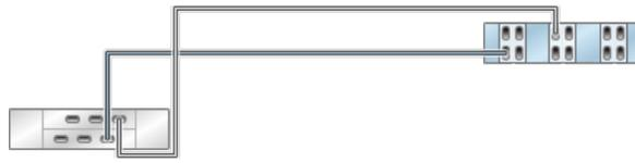
**FIGURE 332** Contrôleur 7420 autonome avec six HBA connectés à deux étagères de disques DE2-24 dans deux chaînes
