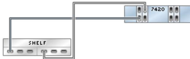
**FIGURE 395** Contrôleur 7420 autonome avec quatre HBA connectés à deux étagères de disques Sun Disk Shelf dans deux chaînes
