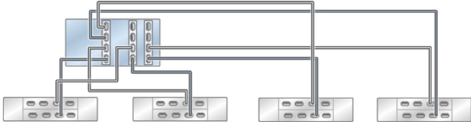
**FIGURE 73** Contrôleur ZS4-4 autonome avec trois HBA connectés à cinq étagères de disques DE3-24 dans cinq chaînes
