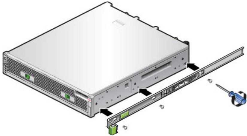
2. En el siguiente gráfico, se muestra cómo fijar los soportes de montaje en un controlador 7x20.
