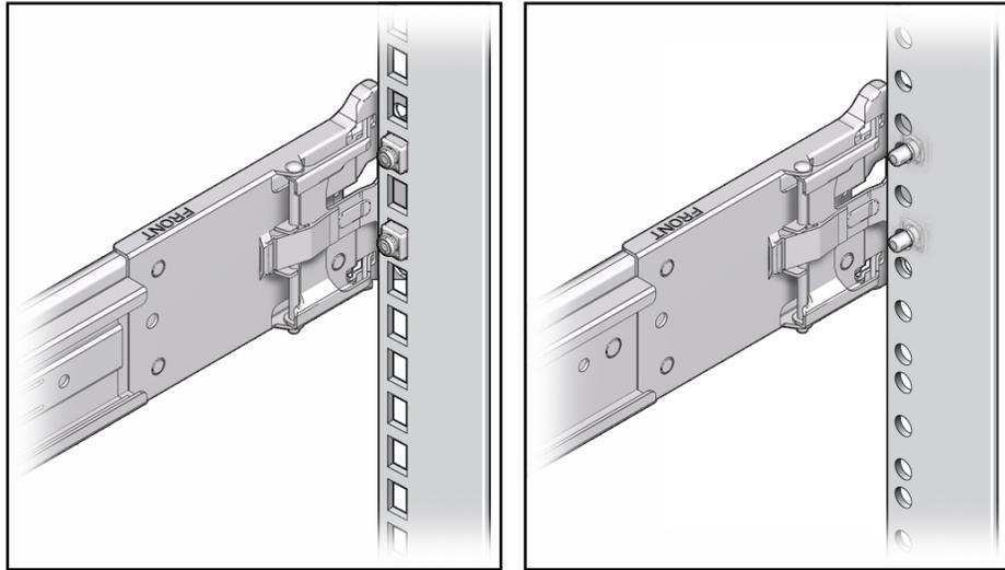
4. (선택사항) 슬라이드 레일 조립품을 나사를 사용하여 랙에 고정하기로 선택했으면 전면 및 후면 슬라이드 레일 브래킷 및 랙 포스트를 모두 통과하도록 M6 마운팅 나사를 삽입한 다음 케이스 너트를 사용하여 나사를 랙 포스트에 고정합니다.
