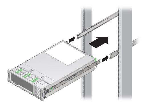
3. Inserte los soportes de montaje en las guías deslizantes y, a continuación, empuje el servidor para introducirlo en el bastidor hasta que los soportes de montaje se encuentren con los topes de las guías deslizantes (aproximadamente 12 in o 30 cm).
