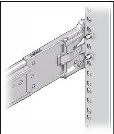
4. (Opcional) Si elige fijar el conjunto de guías deslizantes al bastidor con tornillos, inserte los tornillos de montaje M6 a través de los soportes frontal y posterior
