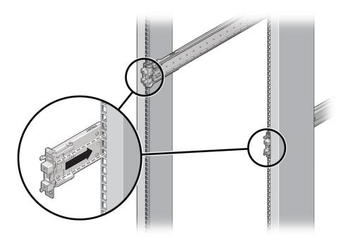
Las clavijas de montaje del conjunto de guías deslizantes admiten orificios de montaje cuadrados de 9,5 mm u orificios de montaje redondos M6. No se admite ningún otro tamaño de orificio de montaje.
