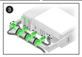
2. Encamine los cables del servidor por los enganches y las correas de cables del organizador de cables.
