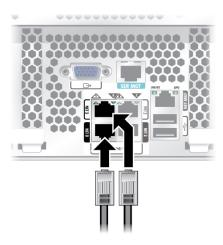
2. Conecte cables de categoría 5 (o superior) del conmutador o concentrador de red al resto de los puertos Ethernet (NET1, NET2 y NET3), según sea necesario.
