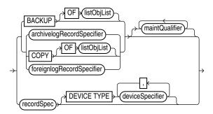
(listObjList::=, archivelogRecordSpecifier::=, maintQualifier::=, deviceSpecifier::=, recordSpec::=)
