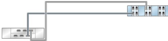
図 361 2つのチェーン内で DE2-24 ディスクシェルフ 2 台に接続された HBA 6 基を搭載するスタンドアロン 7420 コントローラ
