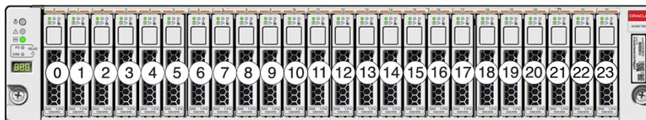
図 693 DE3-24C ディスクシェルフのドライブの位置 (前面図)
