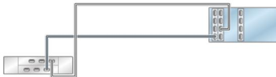
図 215 2つのチェーン内で DE2-24 ディスクシェルフ 2 台に接続された HBA 3 基を搭載するスタンドアロン ZS4-4/ZS3-4 コントローラ
