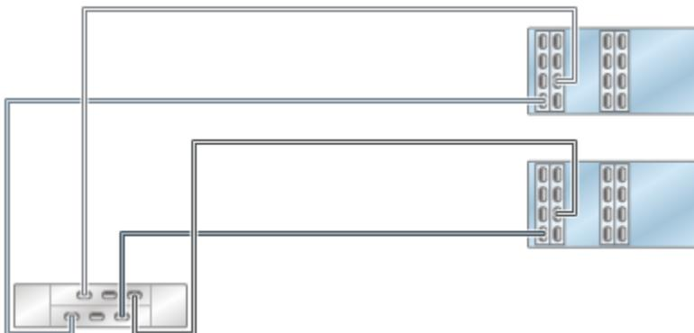
図 317 2つのチェーン内で DE2-24 ディスクシェルフ 2 台に接続された HBA 4 基を搭載するクラスタ化 7420 コントローラ
