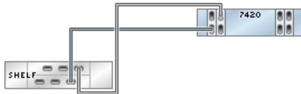
図 346 2つのチェーン内で DE2-24 ディスクシェルフ 2 台に接続された HBA 4 基を搭載するスタンドアロン 7420 コントローラ
