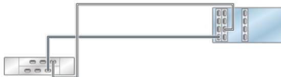
図 285 2つのチェーン内で DE2-24 ディスクシェルフ 2 台に接続された HBA 3 基を搭載するスタンドアロン 7420 コントローラ
