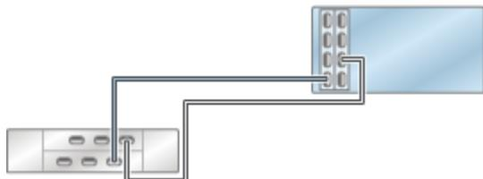
図 209 2つのチェーン内で DE2-24 ディスクシェルフ 2 台に接続された HBA 2 基を搭載するスタンドアロン ZS4-4/ZS3-4 コントローラ
