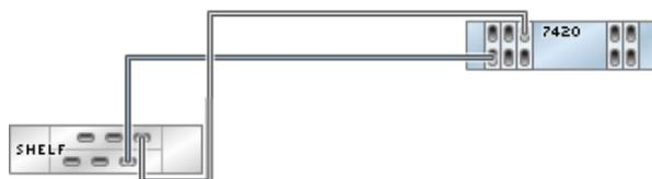
図 353 2つのチェーン内で DE2-24 ディスクシェルフ 2 台に接続された HBA 5 基を搭載するスタンドアロン 7420 コントローラ
