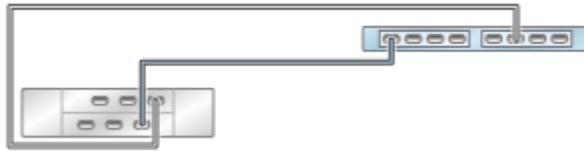
**図 261** 2つのチェーン内で DE2-24 ディスクシェルフ 2 台に接続された HBA 2 基を搭載するスタンドアロン ZS3-2 コントローラ
