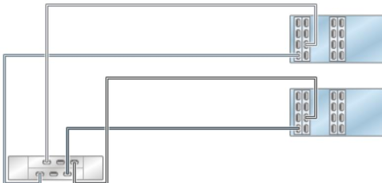
図 247 2つのチェーン内で DE2-24 ディスクシェルフ 2 台に接続された HBA 4 基を搭載するクラスタ化 ZS4-4/ZS3-4 コントローラ
