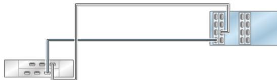
図 223 2つのチェーン内で DE2-24 ディスクシェルフ 2 台に接続された HBA 4 基を搭載するスタンドアロン ZS4-4/ZS3-4 コントローラ
