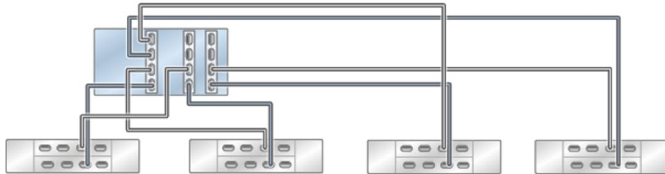
図 102 5つのチェーン内で DE3-24 ディスクシェルフ 5 台に接続された HBA 3 基を搭載するスタンドアロン ZS4-4 コントローラ
