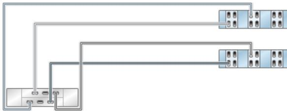
図 396 2つのチェーン内で DE2-24 ディスクシェルフ 2 台に接続された HBA 6 基を搭載するクラスタ化 7420 コントローラ
