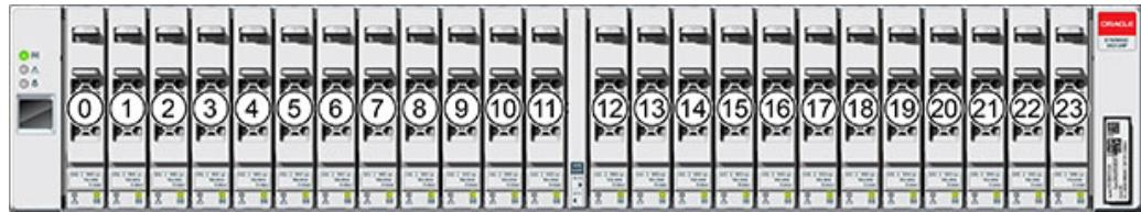
每个磁盘机框最多支持四个优化写入的日志 SSD。应该按插槽 20、21、22 和 23 的顺序填充日志设备。
