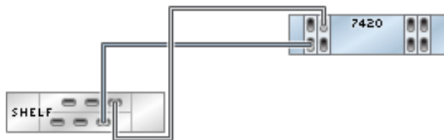
图 346 具有四个 HBA 且通过两个链连接到两个 DE2-24 磁盘机框的单机 7420 控制器
