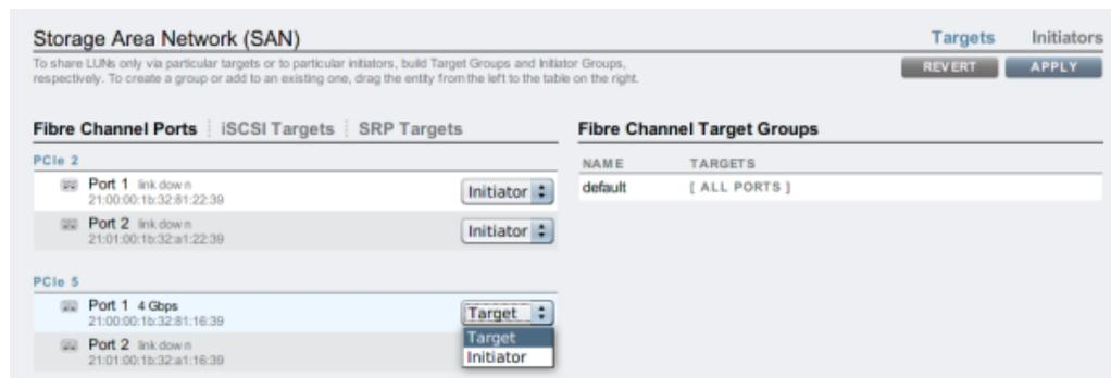
2. 将所需的端口设置为 "Target" (目标) 后, 单击 "Apply" (应用) 按钮。此时将显示一条确认消息, 通知您设备将立即重新引导。确认您要重新引导。
