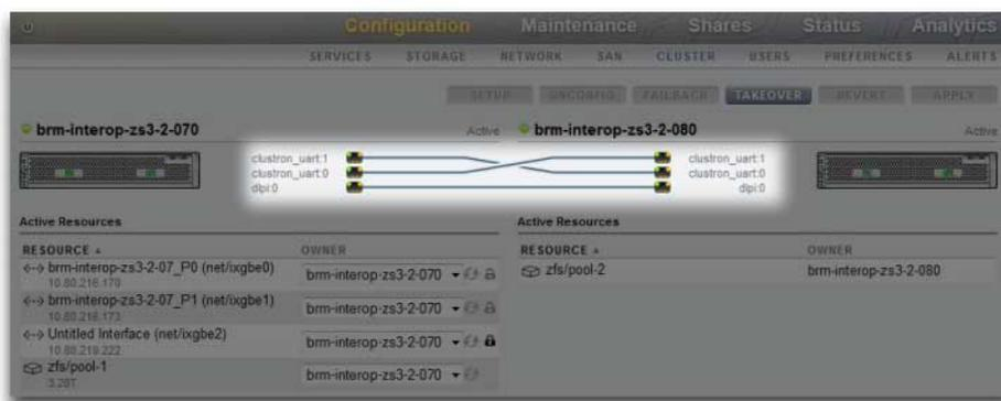
幸运的是，大多数此类故障情形都由人为错误引起，可通过正确安装硬件和对员工进行群集设置和管理最佳做法方面的培训来全面预防。管理员始终都要确保三条群集 I/O 链路全部都已连接且正常运行（参见图），并按照设备随附的安装说明页中所示连接所有存储电缆。特别重要的一点是，将群集投入生产环境前以及此后必须能检测到每个磁盘机框有两个路径（参见图），临时更改布线来支持容量增加或更换故障组件当然除外。
