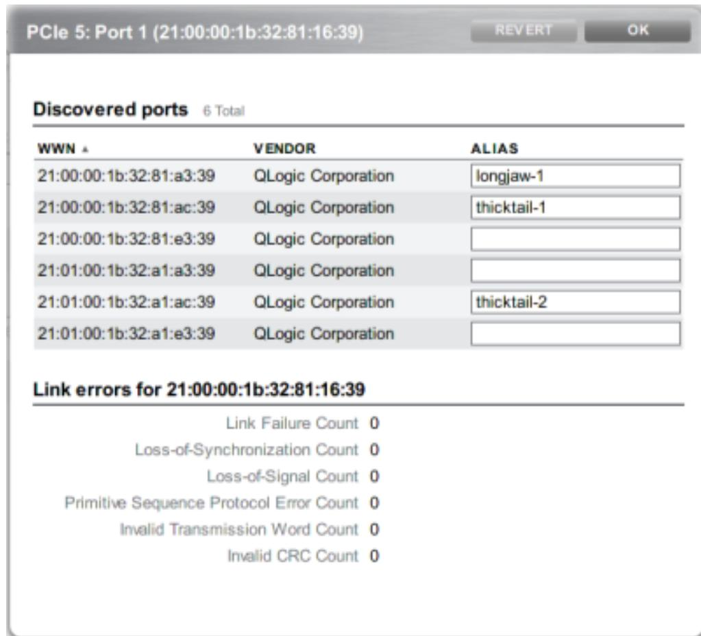
2. 在 "Discovered Ports" (搜索到的端口) 对话框中, 单击列表中的 **WWN** 可查看关联的链路错误。
