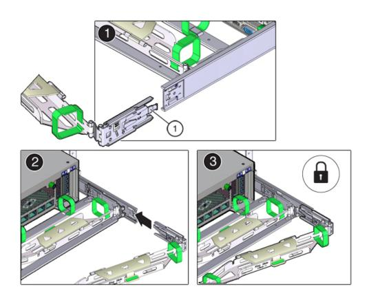
10. CMA의 커넥터 D를 설치하도록 준비하려면 커넥터 D에 슬라이드 레일 래치 브래킷을 고정하는 테이프를 제거하고 래치 브래킷이 커넥터 D와 제대로 맞춰져 있는지 확인합니다(프레임 1 및 2).
