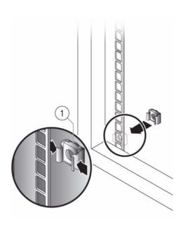
6. 슬라이드 레일 조립품의 양쪽 끝에 있는 브래킷이 전면 및 후면 랙 포스트 바깥쪽에 위치하도록 랙에 슬라이드 레일 조립품을 배치합니다. 다음 그림은 레일 조립품 브래킷을 설명합니다.
