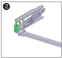
11. 슬라이드 레일 래치 브래킷을 제자리에 고정한 상태로 커넥터 D 및 해당 슬라이드 레일 래치 브래킷을 커넥터 D가 찰칵 소리를 내며 잠길 때까지 왼쪽 슬라이드 레일로 삽입합니다(프레임 1 및 2).
