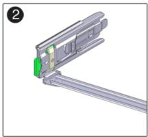
11. 슬라이드 레일 래치 브래킷을 제자리에 고정한 상태로 커넥터 D 및 해당 슬라이드 레일 래치 브래킷을 커넥터 D가 찰칵 소리를 내며 잠길 때까지 왼쪽 슬라이드 레일로 삽입합니다(프레임 1 및 2).
