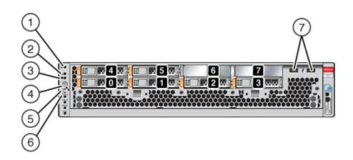
드라이브 슬롯 0과 1에는 미러링된 SAS-2 부트 드라이브가 두 개 있습니다. 최대 4개의 읽기 캐시 SSD로 슬롯  $2\sim5$ 를 순서대로 채울 수 있습니다. 슬롯 6과 7은 비어 있으며 드라이브 필러가 있어야 합니다. 지원되는 HDD 및 SSD에 대한 자세한 내용은 Oracle Systems Handbook을 참조하십시오.
