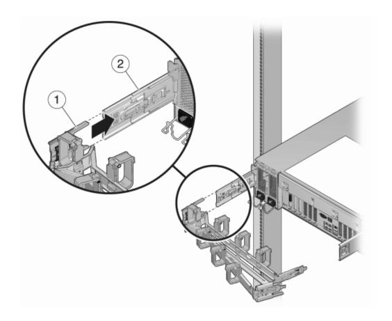
5. 조립품에서 케이블을 설치하고 경로를 지정한 후 후크와 루프 스트랩(1)을 연결하여 케이블을 고정합니다. 그런 다음 오른쪽 및 왼쪽 외부 래치를 연결하여 조립품을 지지합니다.
