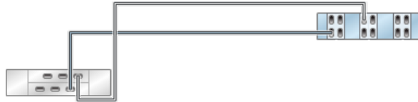
그림 361 독립형 7420 컨트롤러의 HBA 6개가 DE2-24 Disk Shelf 2개에 2줄 체인으로 연결됨
