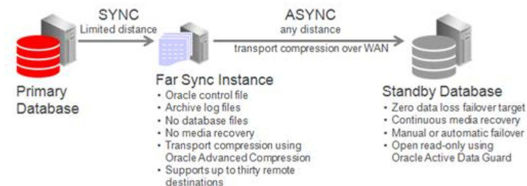
図14-1 遠隔同期アーキテクチャの概要
