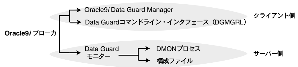
図 1-2 Oracle9i Data Guard Broker のコンポーネント
