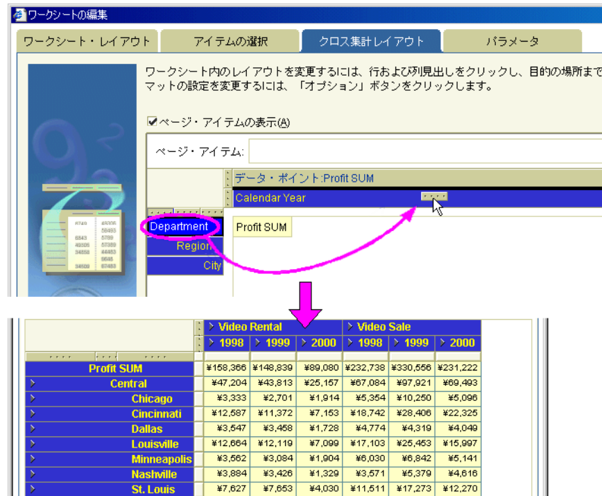
図 9-2 「ワークシートの編集」ダイアログの「クロス集計レイアウト」タブでのピボット
