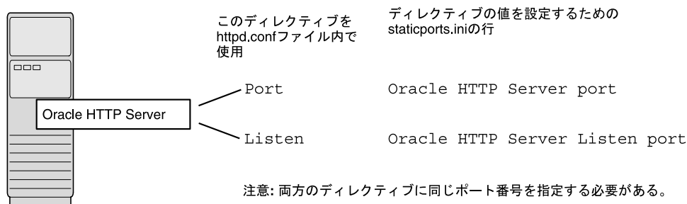
図 3-2 Oracle HTTP Server のみの構成
