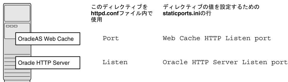
図 3-1 OracleAS Web Cache および Oracle HTTP Server の構成
