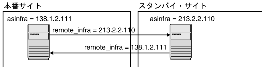
図 10-3 内部 DNS サーバー内の Oracle Data Guard エントリ
