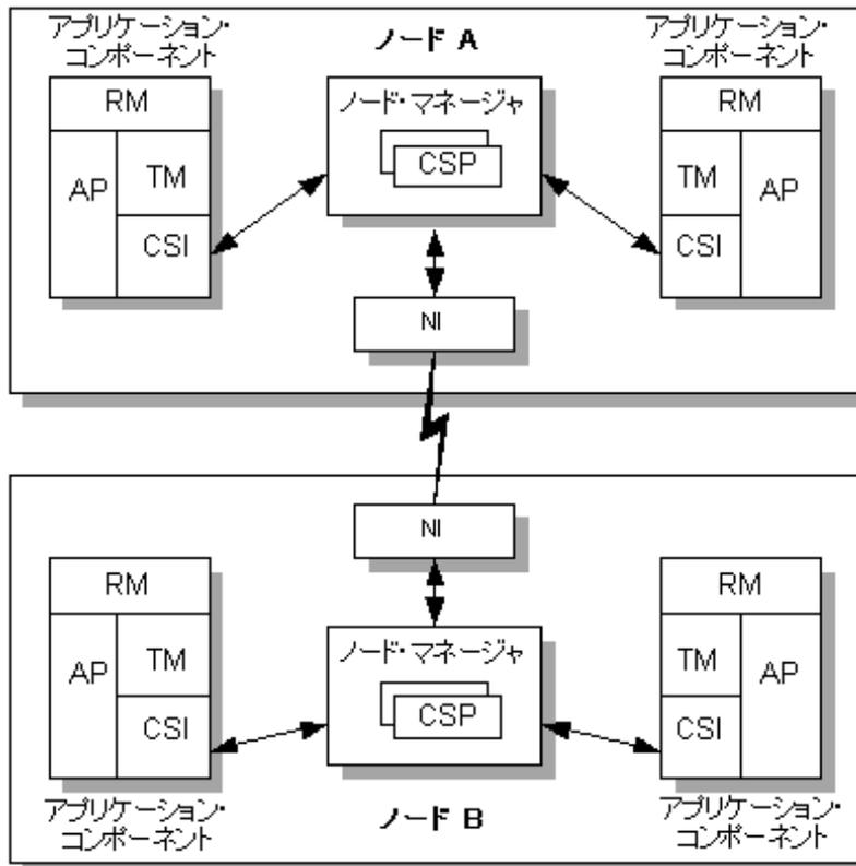
図に示すように、BEA TOP END システムは1つ以上のノードで構成されます。基本ノードには、クライアント、ノード・マネージャ、およびサーバが含まれます。
