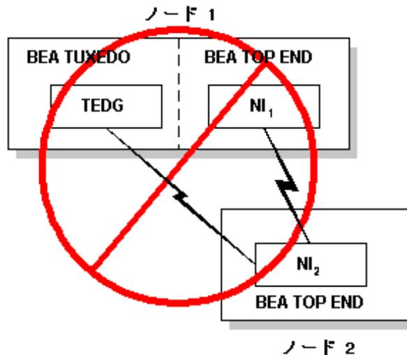
上の図では、単一の物理ノード「ノード 1」が 2 つの論理ノード、つまり、BEA Tuxedo システムの TEDG と BEA TOP END システムの NI<sub>1</sub> をサポートしています。このシナリオでは、ノード 1 の TEDG がノード 2 の NI<sub>2</sub> に対する NI として機能します。ただし、ノード 1 に別の NI (この場合は BEA TOP END システムのノード 1 にある NI<sub>1</sub>) が接続されている場合、TEDG はノード 2 の NI<sub>2</sub> には接続できません。
