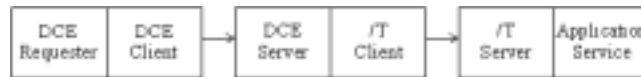
図 4-2 BEA Tuxedo ゲートウェイを用いた BEA Tuxedo サービスに対する DCE 要求者
