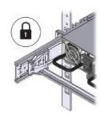
c CMAのコネクタBを、カチッと音がして定位置に固定されるまで、左側のスライドレールの前面スロットに差し込みます。
