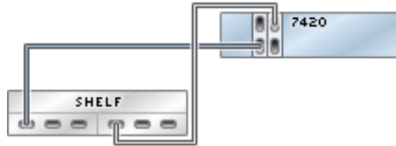
그림 451 독립형 7420 컨트롤러의 HBA 2개가 Sun Disk Shelf 2개에 2줄 체인으로 연결됨
