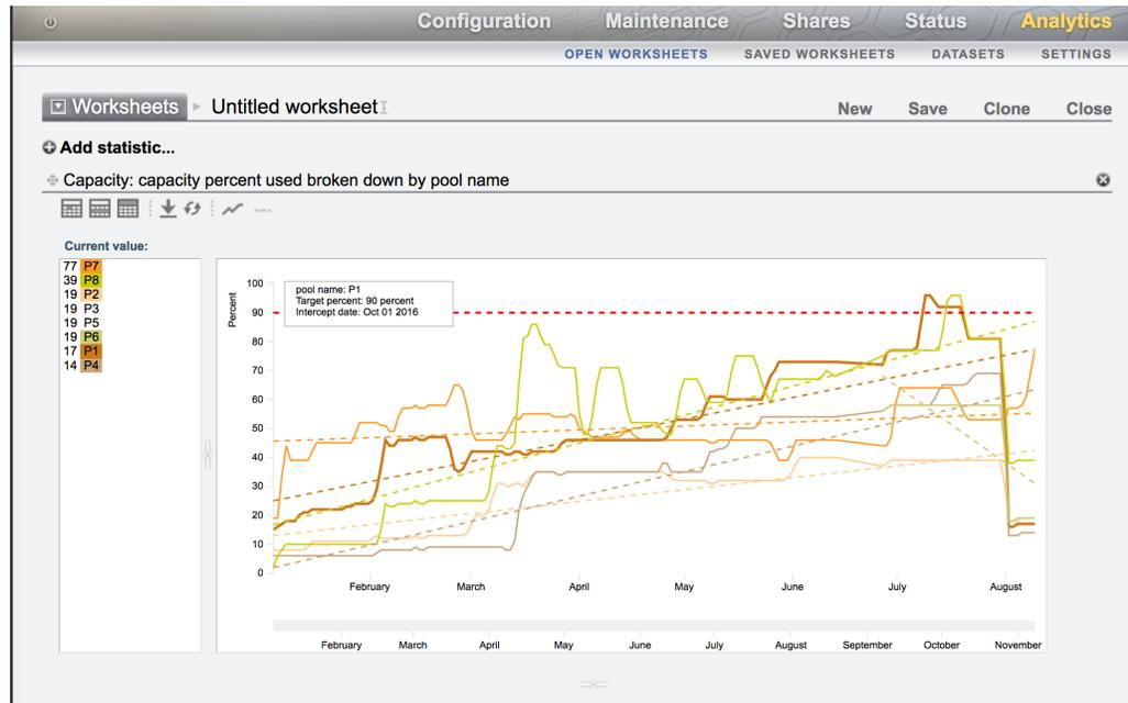
빨간색 점선은 참조선이고, 다른 점선은 개별 추세를 보여줍니다. 실선은 실제 사용 용량을 반영합니다. 점선(빨간 점선으로 된 참조선 제외)은 현재 값 창에 나와 있는 것처럼 스토리지 풀과 연관된 색상과 일치하도록 실선으로 색상이 구분됩니다. 마우스로 Current value(현재 값) 창에 있는 풀을 가리키면 풀 이름, 대상(또는 참조) 백분율 및 가로채기 날짜가 상자에 표시됩니다. 가로채기 날짜는 풀이 대상(또는 참조) 백분율에 도달하는 시기입니다. 마우스로 그래프에 있는 풀을 가리키면 해당 시점에 대한 용량이 표시됩니다.
