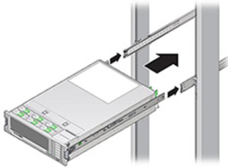
5. **Mantenga pulsados simultáneamente los botones de apertura verdes de las guías deslizantes de cada soporte de montaje a la vez que introduce el chasis en el rack. Continúe empujando hasta que los bloqueos de las guías deslizantes (en la parte frontal de los soportes de montaje) se acoplen a los conjuntos de guías deslizantes.**
