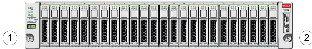
8. **Si se envió el estante de discos montado en rack, instale un tornillo [1 y 2] en cada reborde trasero del chasis [A].**
