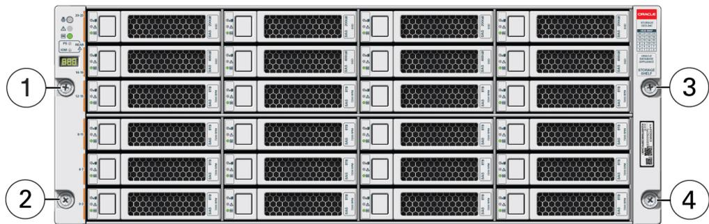
9. Si se envió el estante de discos montado en rack, instale un tornillo [1 y 2] en cada reborde trasero del chasis [A].
