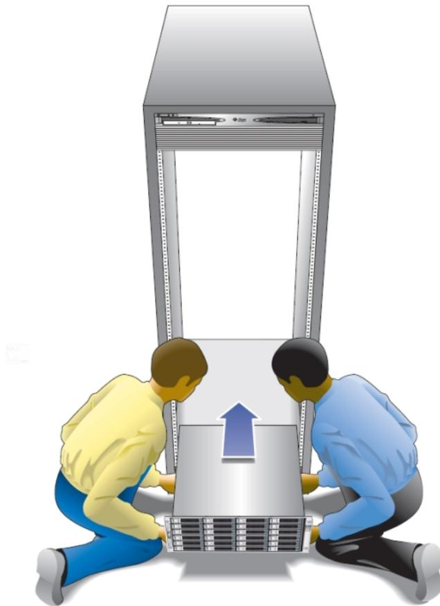
7. Deslice cuidadosamente el estante dentro del armario hasta que las pestañas delanteras del estante toquen la cara vertical del rack.
