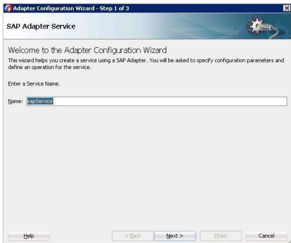
サービス名を指定し、ウィザードでのアダプタ・サービスの定義が完了すると、この名前が付いたWSDLファイルがアプリケーション・ナビゲータに表示されます。
