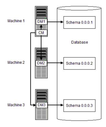
Figure 28-1 Sample Multischema System
