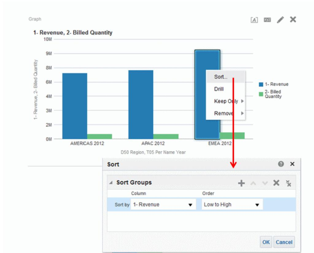
下列的圖顯示含有 1 - Revenue 和 2 - Billed Quantity 這兩個計量之垂直長條圖的排序結果。這兩個計量依 T05 Per Name Year 分組、依 D50 Region 提示，然後依 1 - Revenue 以低至高順序排序。
